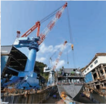
200T走行式ジブクレーン 200T Travelling Jib Crane
