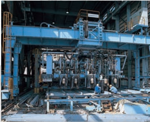
10電極ロンジ溶接装置 Electrode line welder
