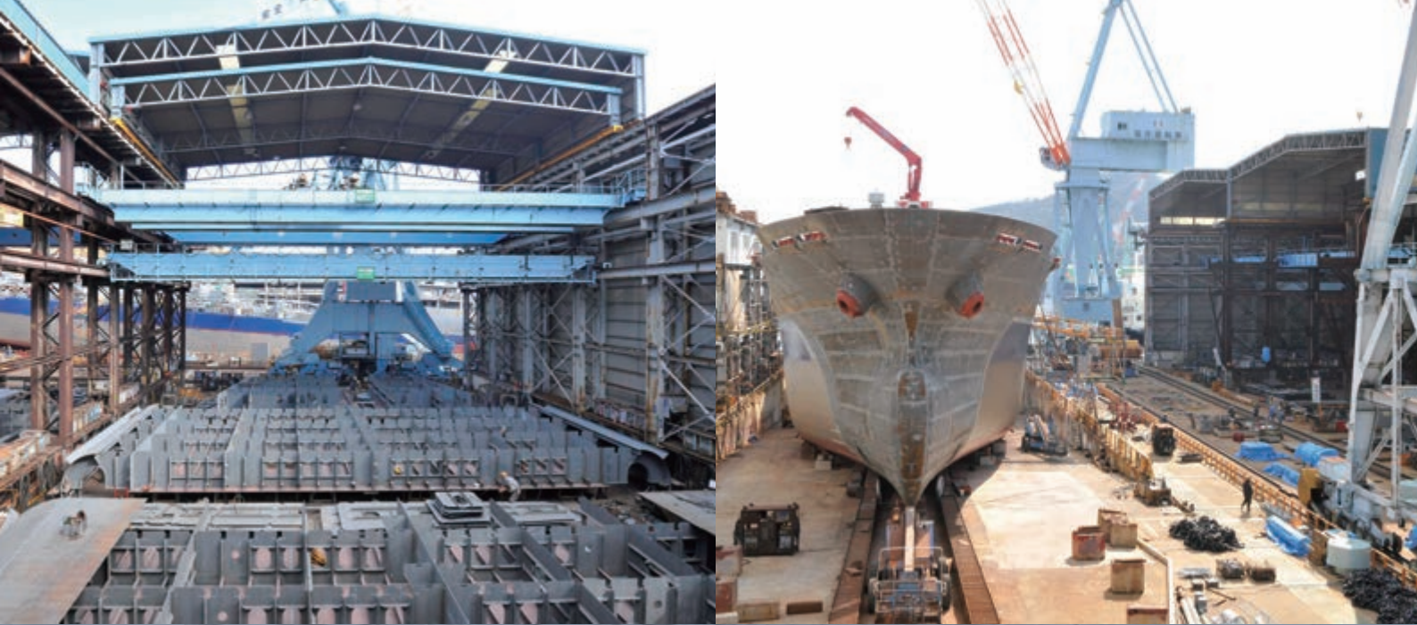
全天候型走行式ブロック工場 All-weather type Block assembly shop with a Travelling roof
