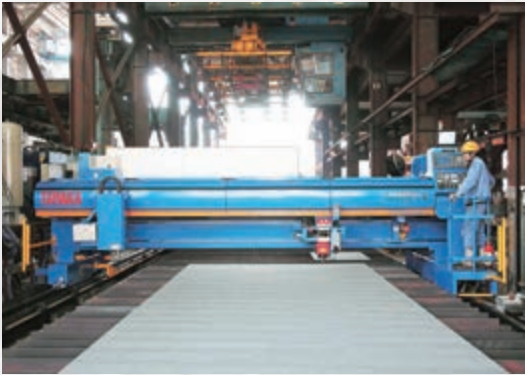
NCLレーザー切断装置 NC Laser cutting equipment
